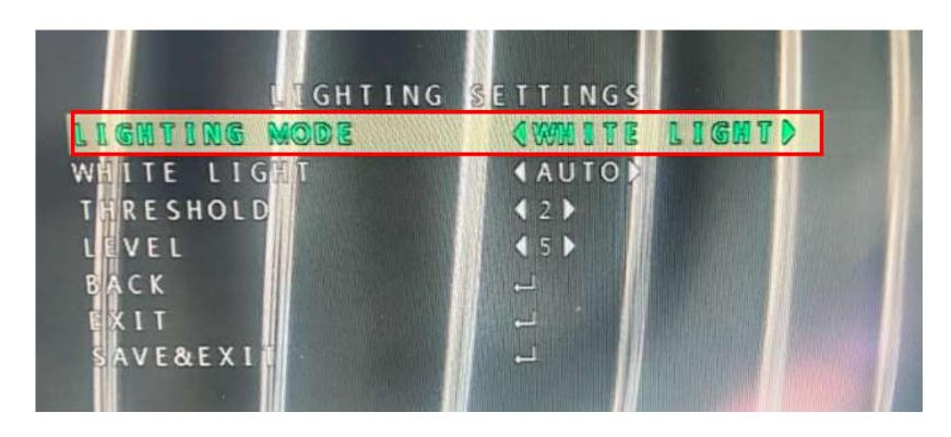
「LIGHTING MODE」を選択した状態で左右の操作をすることでモードの切り替えができます。
