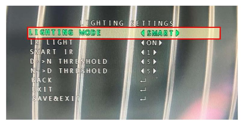
「SMART」は対応しているレコーダーにてイベント発生時にLEDを 照射することができるようにする設定です。夜間イベントが発生す るまではIR照射、イベントが発生したらLEDに切り替わります。LED はイベントが終了してから1分ほど照射されIRに戻ります。
