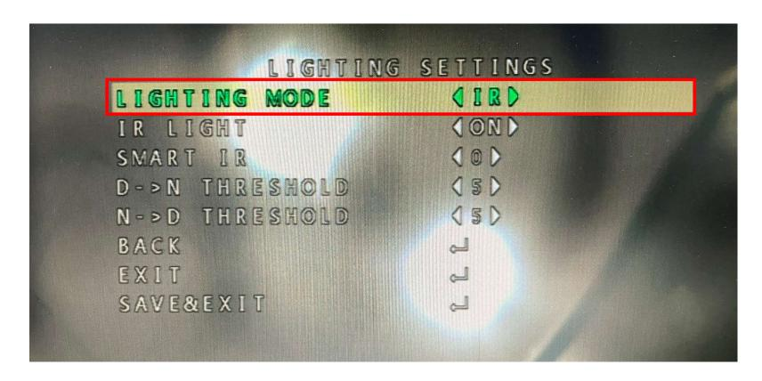
「IR」は画面が暗くなったとき、IRを照射して画面が見えるようにします。IRカメラの交換機として本機を使用される際に選択ください。
