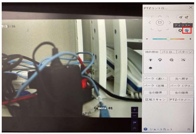
PTZコントロールウィザードが消えてPTZコントロールパネルが表示されます。 「アイリス+」をクリックします。
