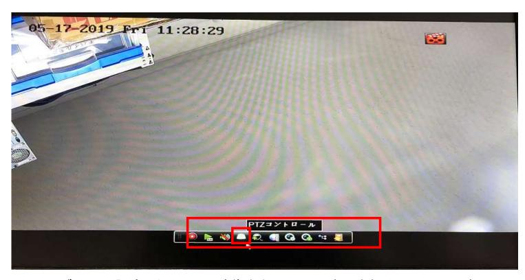
ライブ画面で設定したいカメラ映像を左クリックし表示されるアイコンのバー内の「PTZコントロール」をクリックします。
