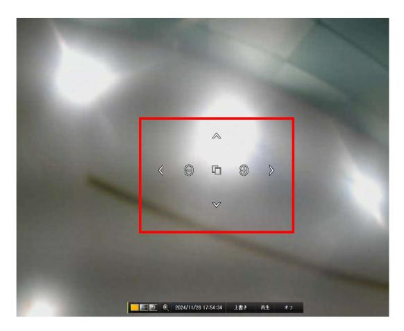
画面上に上下左右のマークが表示された状態で右クリックをします。
